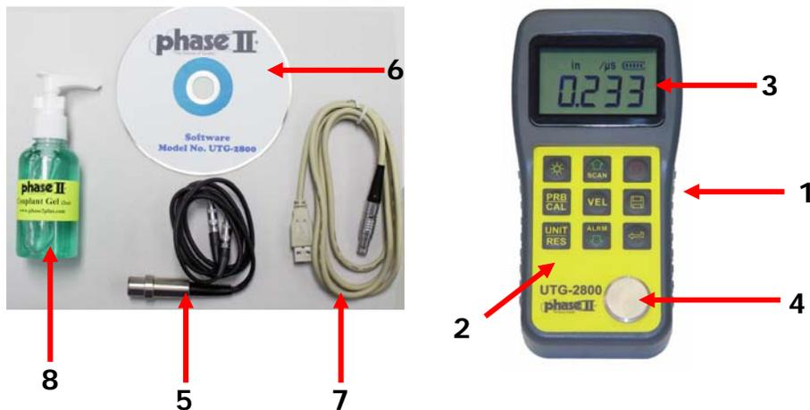
1) Base Instrument 2) Keypad 3) LCD display 4) Calibration Block 5) Dual Sensor Probe 6) Software 7) USB Output Cable 8) Couplant Gel
